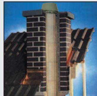
52 После облицовки дымохода в качестве завершающего элемента используйте покрывную плиту и конус. Покрывную плиту Вы можете получить в виде готового элемента или изготовить непосредственно на месте. В «Комплекте для монтажа верхней части дымовой трубы» содержится отдельная инструкция по бетонированию покрывной плиты на строительной площадке.
