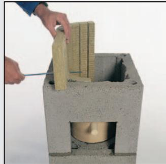
6 Согните изоляционную панель прорезями внутрь и вставьте в каменный блок так, чтобы соединение двух элементов изоляции находилось посередине задней стенки. Излишки изоляции обрежьте специальной пилой, входящей в «Основной комплект».
