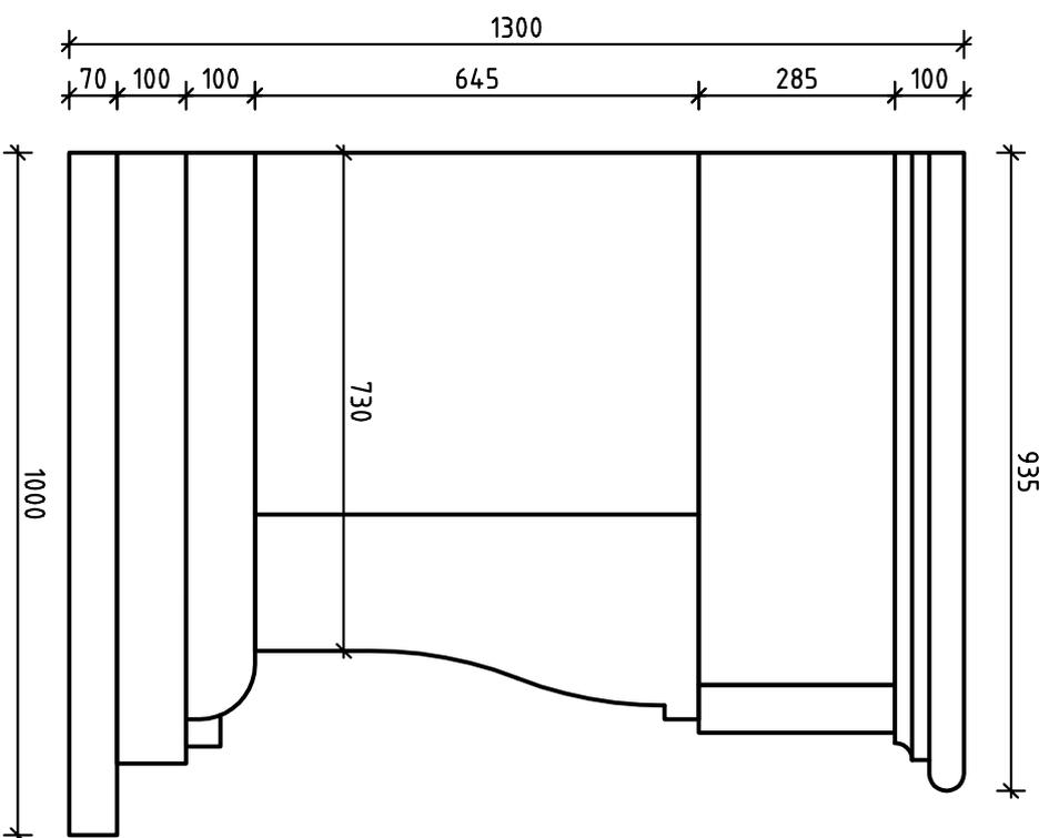
Все детали из профиля и других крепеж стыкуются с технологической фаской 2-5 мм, в зависимости от твердости используемого материала.
