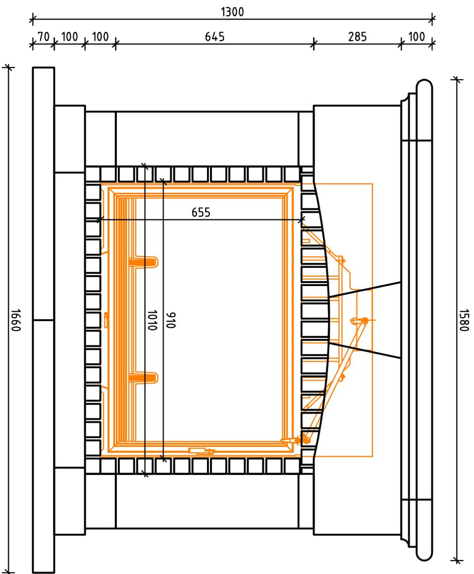
Все детали из кирпича и других камней стыкуются с технологической фаской 2-5 мм, в зависимости от твердости используемого материала.
