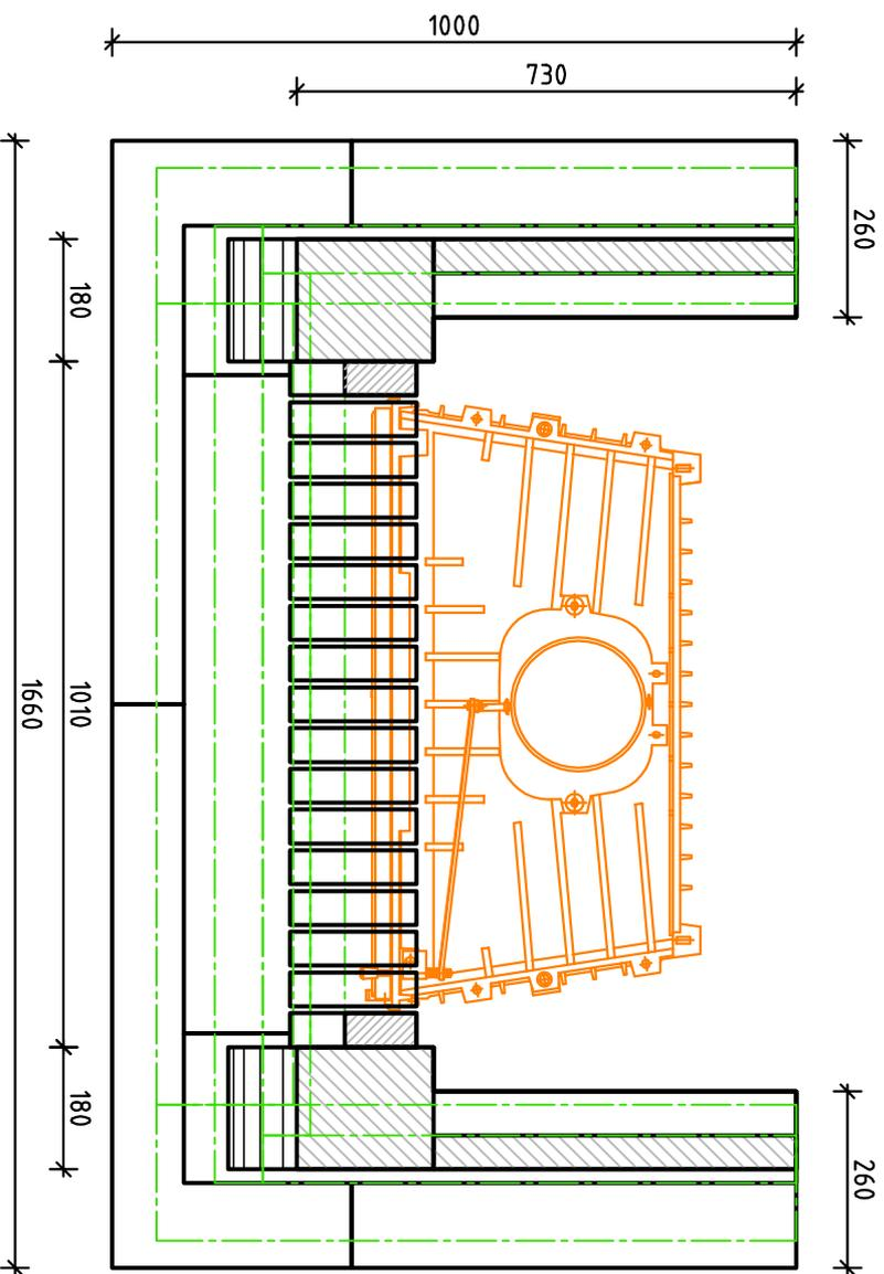
Все детали из кирпича и других камней стыкуются с технологической факкой 2-5 мм, в зависимости от твердости используемого материала.
