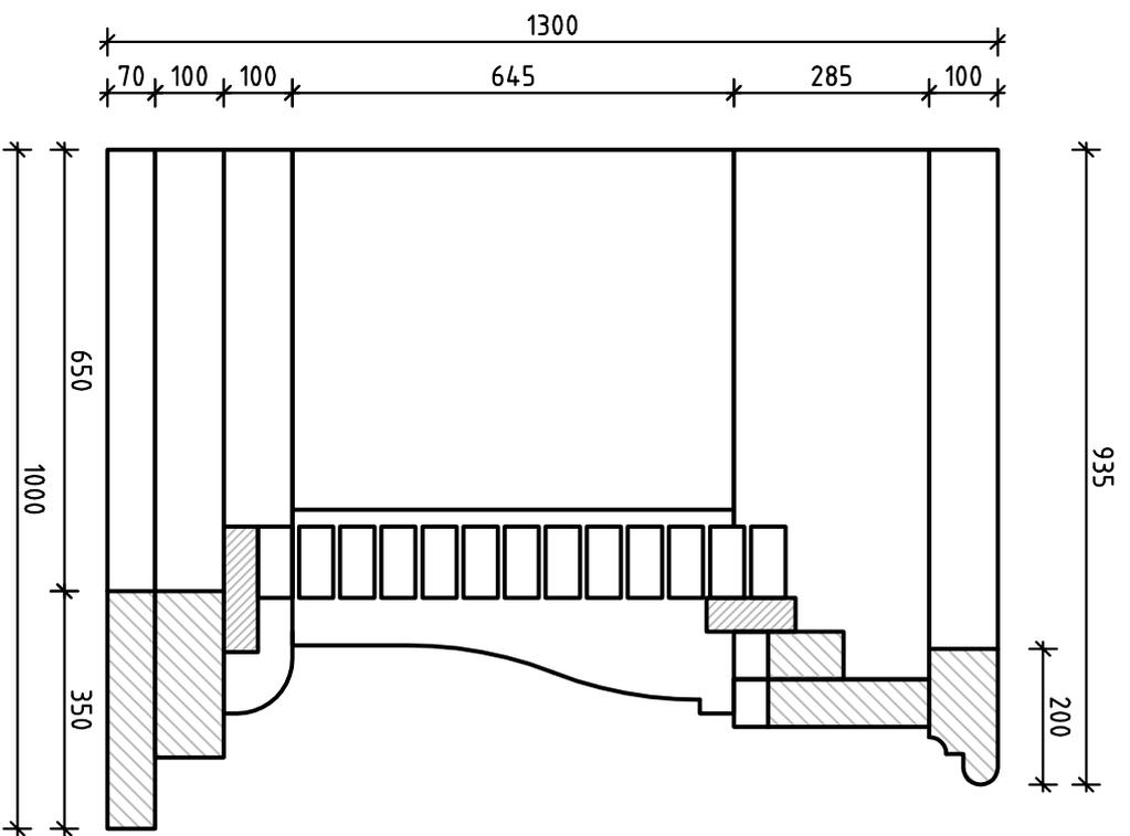
Все детали из кирпича и других камней стыкуются с технологической факкой 2-5 мм, в зависимости от твердости используемого материала.
