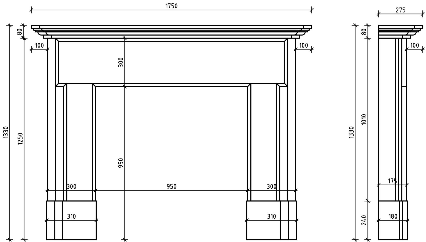
Все детали из мрамора и других камней стыкуются с технологической фаской 2-5 мм, в зависимости от твердости используемого материала.
