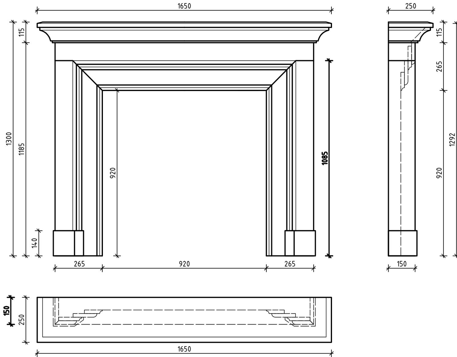
Все детали из мрамора и других камней стыкуются с технологической фаской 2-5 мм, в зависимости от твердости используемого материала.
