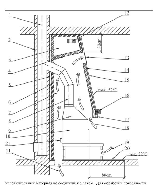
Вертикальный разрез камина с одним кожухом и закрытой топочной камерой 5. Руководство по обслуживанию
