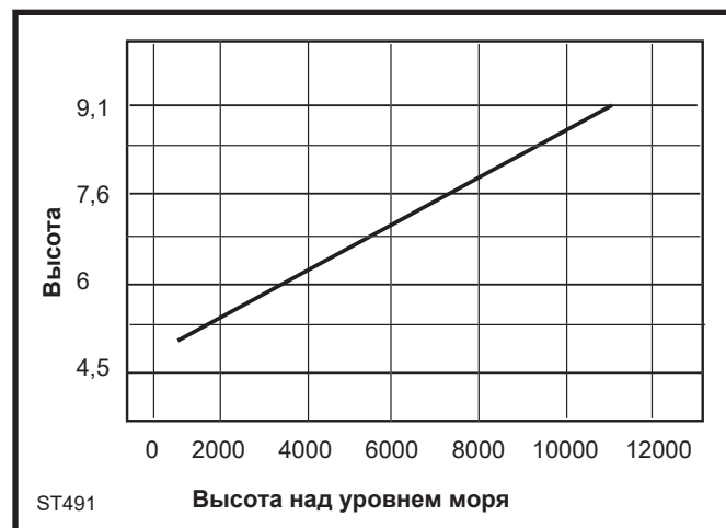
Рис. 2 Требуемая высота для 6-дюймовой трубы и/или для соединителя с трубой.
