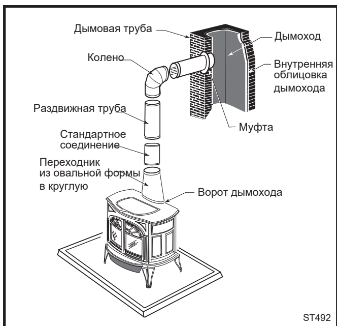
Рис. 6 Перспективное изображение соединения с дымовой свободностоящей трубой из кирпичной кладки.
