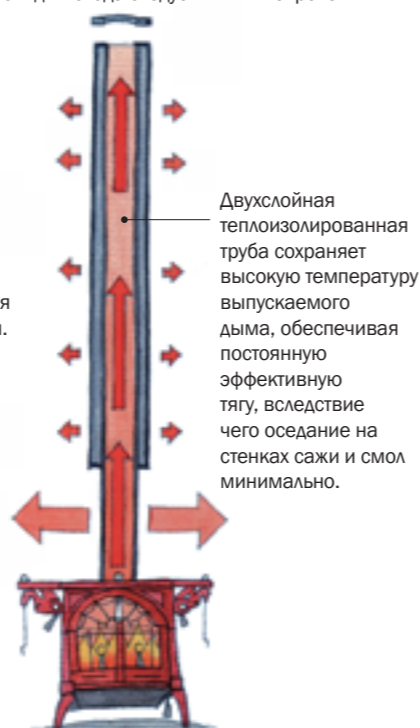
Одинарная труба (слева) подвержена оседанию на ее стенках сажи и смол, что грозит возгоранием. Двухслойная теплоизолированная труба (справа) полностью обеспечивает эффективное горение топлива и нагревательную функцию дровяной печи.
