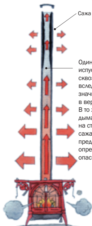
Одинарная труба (слева) подвержена оседанию на ее стенках сажи и смол, что грозит возгоранием. Двухслойная теплоизолированная труба (справа) полностью обеспечивает эффективное горение топлива и нагревательную функцию дровяной печи.
