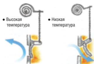
Идеальное горение поддерживается устройством функции автоматического регулирования температуры.
