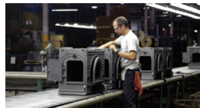
■ Ручная сборка печей на заводе «Vermont Castings».
