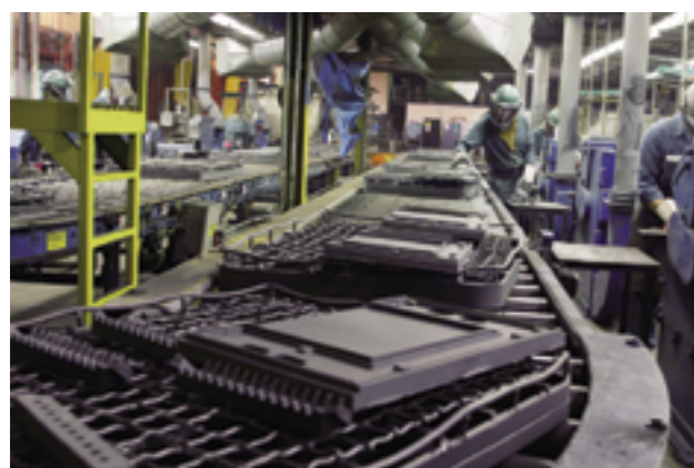
■ Специализация завода «Vermont Castings» — чугунное литье. Каждая деталь для дровяных печей производится под строгим контролем.
