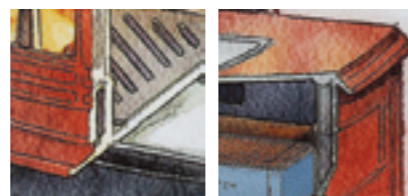
Слева: для увеличения герметичности при закрытой створке дверцы, согласно точному расчету, вторая створка плотно входит в паз с помощью фиберглассового шнура.
