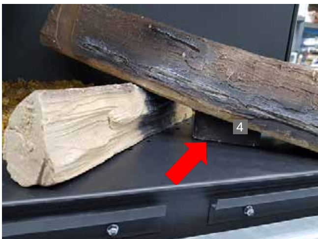
Фото 6: монтаж деталей, этап 2: проследите, чтобы горелка опиралась непосредственно на основание (низ) топки. Между горелкой и основанием топки не должны находиться какие-либо декоративные материалы.
