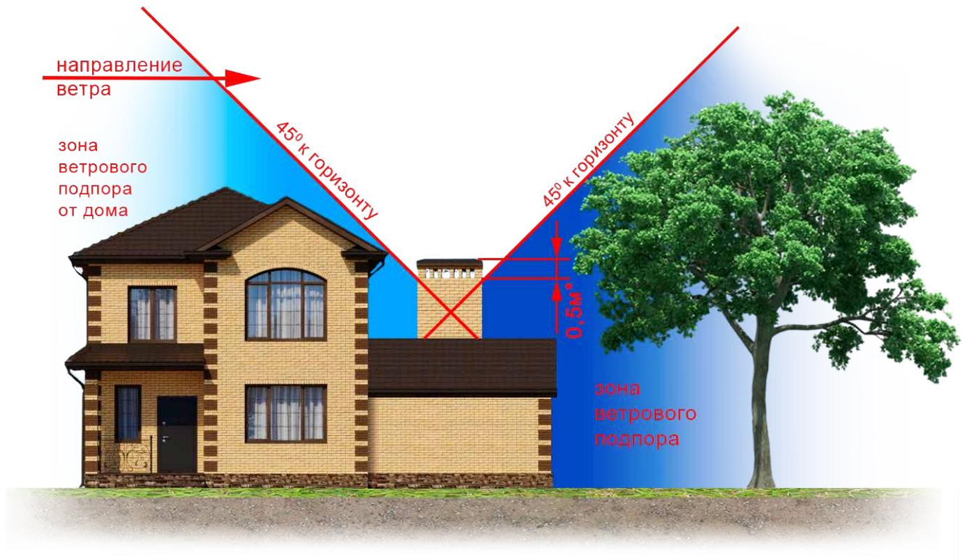
**2.3.3** Зона ветрового подпора определяется плоскостью, проходящей под углом 45 градусов к горизонту через наиболее высокую линию соседнего здания или другого сооружения, деревьев.
