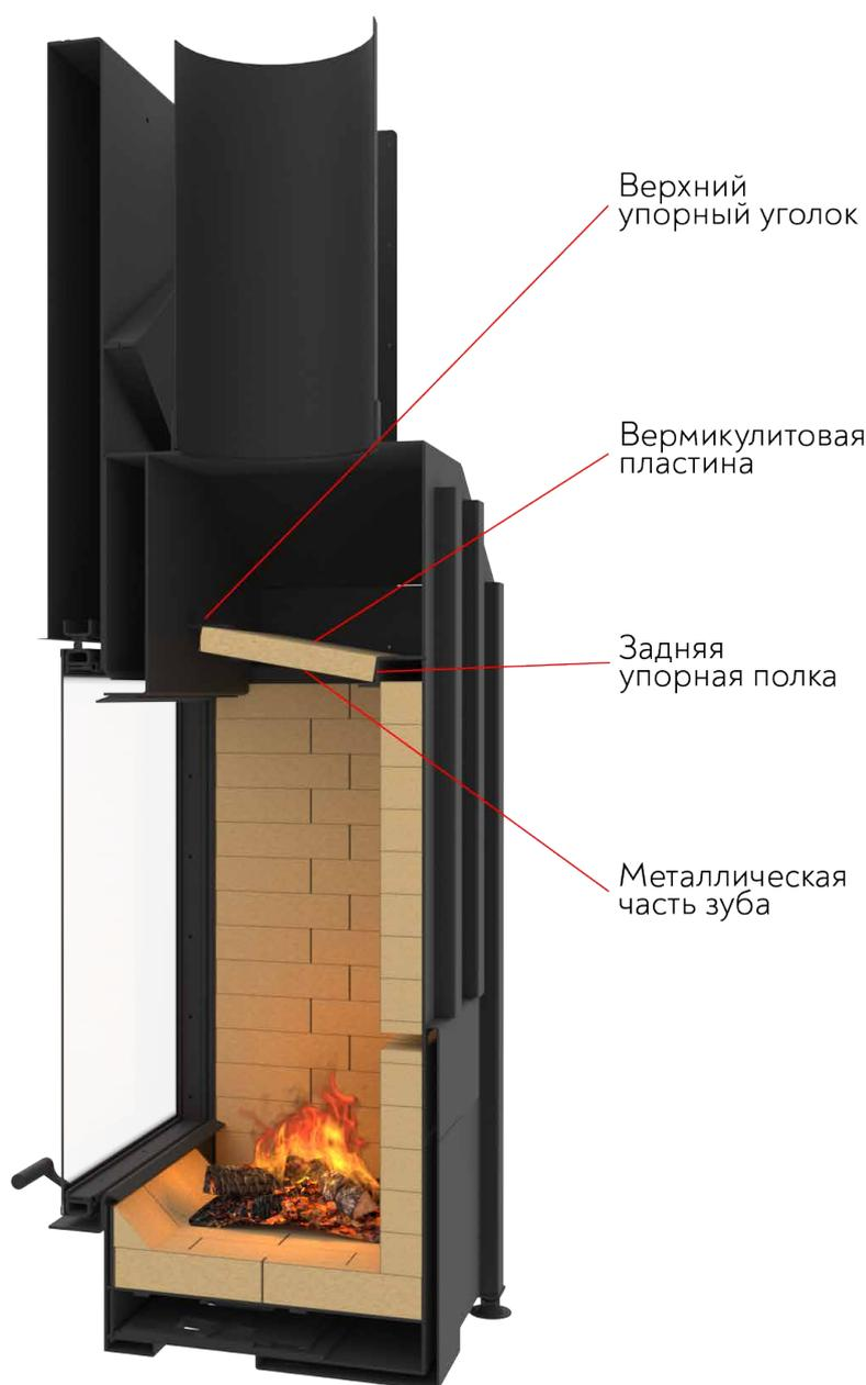
**2.2.12** Дефлектор (дымовый зуб) – специальная пластина, расположенная в верхней части топочной камеры. Служит для изменения направления движения дымовых газов и является значимой деталью каминной топки, благодаря которой существенно повышается КПД. Дымовые газы совершают дымооборот в топке (в зависимости от конструкции дефлектора, может и не один раз), что приводит к значительному увеличению теплоотдачи.
