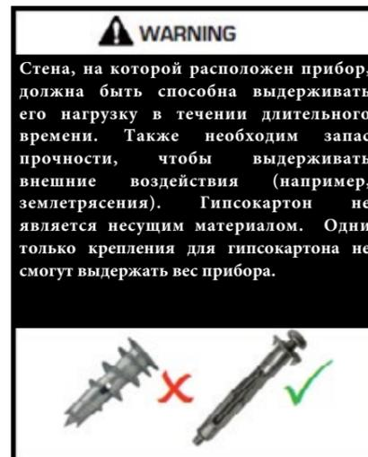
Регулярно проверяйте надежность креплений. Также проверьте кабель питания и соединения. При повреждении кабеля он должен быть заменен квалифицированным специалистом.
