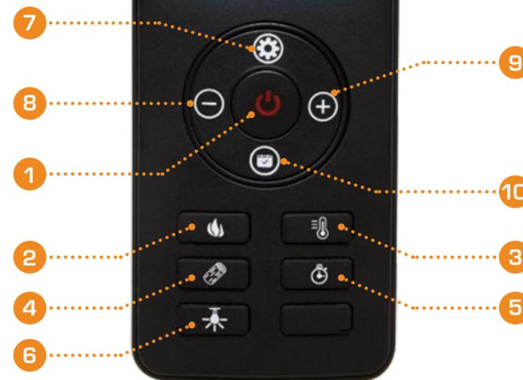
**4) Топливный слой** Меняет цвета основания L1, L2, L3, L4, L1 (круговая настройка)
