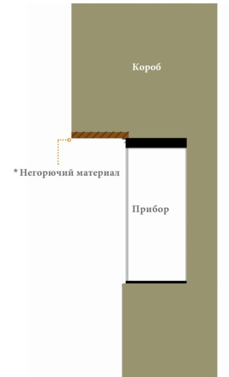
\* Если короб выступает вперед непосредственно над прибором, то нависающая секция должна быть изготовлена из негорючего материала, например, силиката кальция или другого огнеупора.
